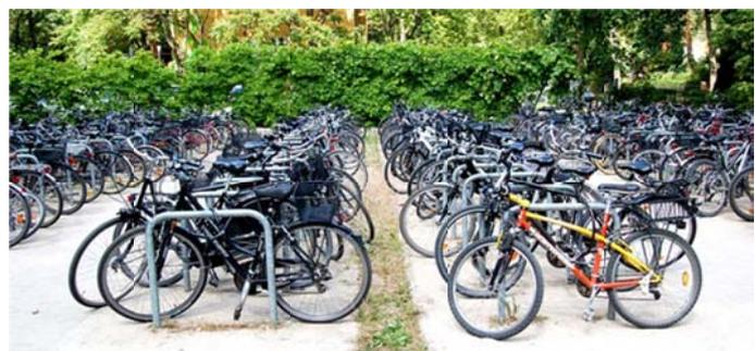
Das Weinberggymnasium ist qualitativ unter den erhobenen Schulen am besten, quantitativ am zweitbesten mit Fahrradhaltern ausgestattet. Dennoch fehlen noch etliche, da die Nachfrage sicher nicht an einem Spitzentag erhoben wurde und außerdem die gerade entlassenen Abiturienten bereits fehlten. Zusätzliche Fahrradbügel sollten 50 % länger als die bisherigen sein, die 80 cm lang und 80 cm hoch
