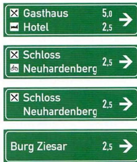
Abb. 70: „Objektwegweiser“ aus den HBR (S. 2/48)
