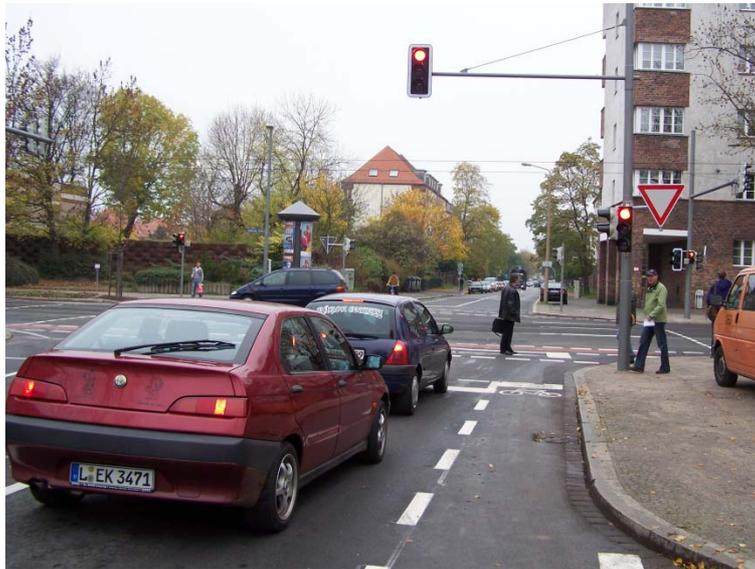
Abb. 15:        Vorbeifahrtstreifen in einer signalisierten Knotenpunktzufahrt mit zusätzlicher Rotmarkierung (Leipzig)
