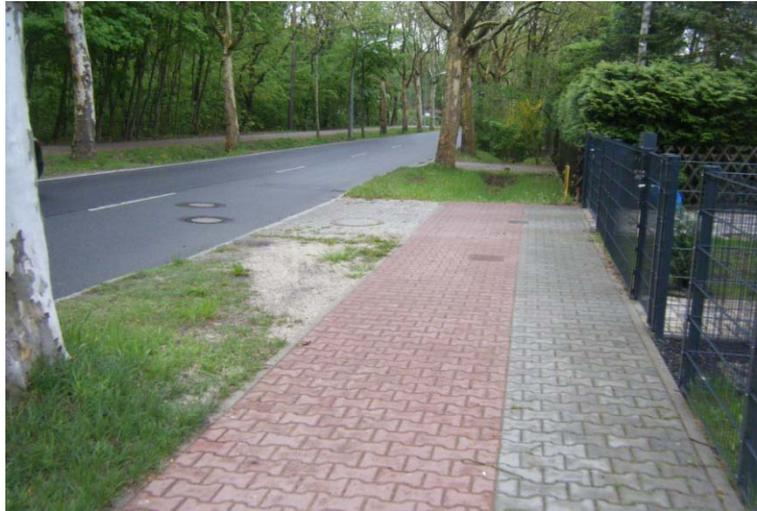
Abb. 29: Ende des Radweges im Stahnsdorfer Damm. Lückenschluss als einseitiger Schutzstreifen empfohlen.
