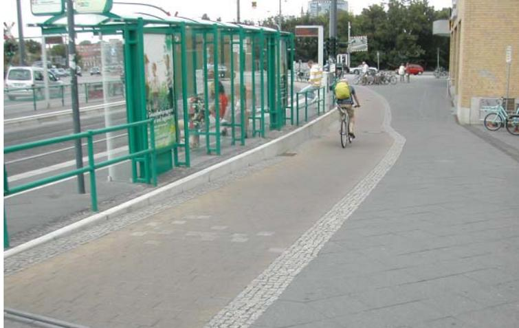
Abb. 5: Vom Gehweg durch eine taktil erfassbare Pflasterung getrennter Radweg (Potsdam)
