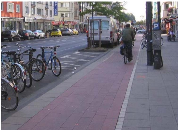
Abb. 42: Radwegbauweise mit ungefastem Pflaster, grauem Sicherheitstrennstreifen (Gehwegplatte) und Begrenzung zum Gehweg (Köln)
