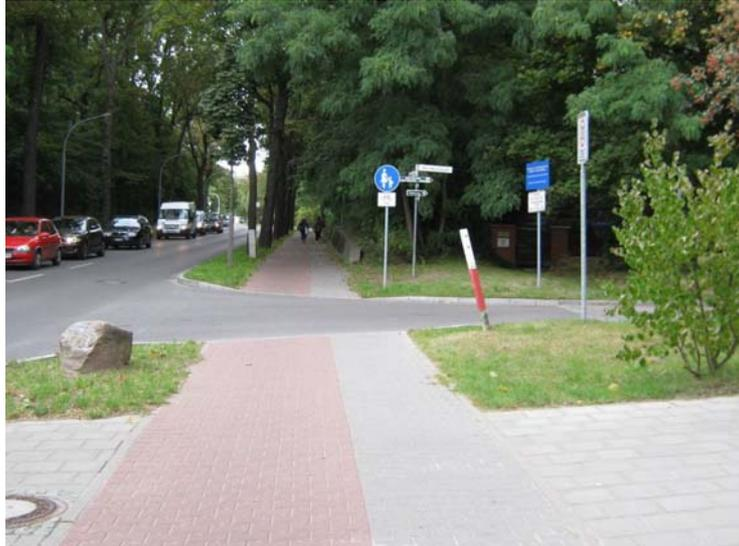
Abb. 25: Nicht benutzungspflichtiger Radweg neben schmalen Gehweg und Ausweisung als Gehweg/Radverkehr frei. Furtmarkierung erforderlich (Stahnsdorfer Damm).
